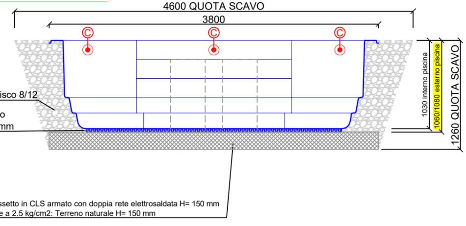
**UNICA INDICAZIONE VALIDA PER LA REALIZZAZIONE DEL BASAMENTO: PENDENZA DELL' 10,5%**
