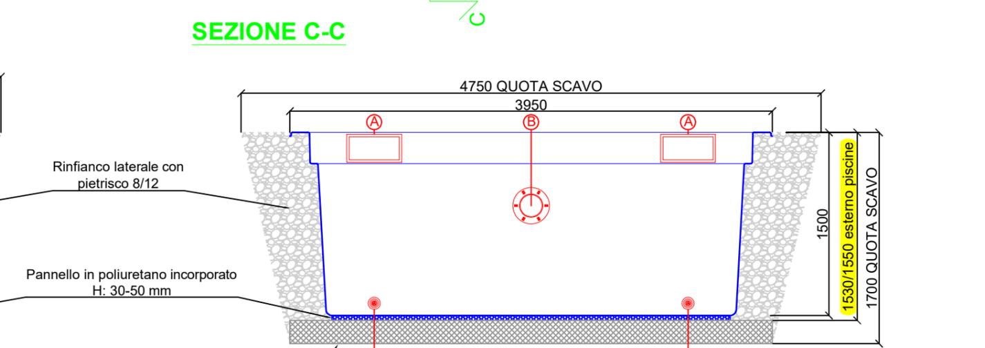
Per portanza inferiore a 2.5 kg/cm<sup>2</sup>: Massetto in CLS armato con doppia rete elettrosaldata H= 150 mm
