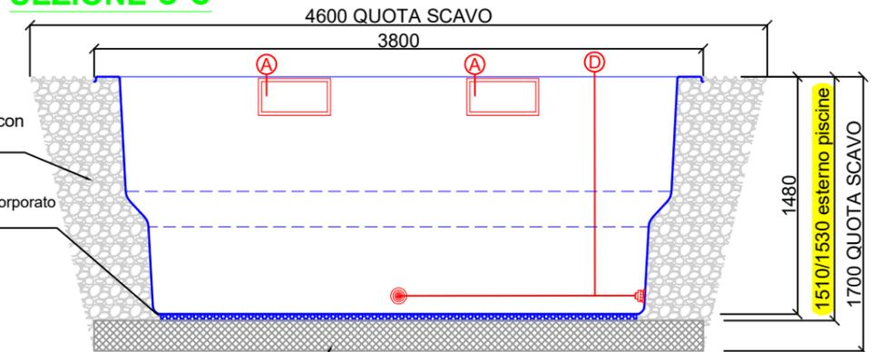
Per portanza inferiore a 2.5 kg/cm2: Massetto in CLS armato con doppia rete elettrosaldata H= 150 mm
