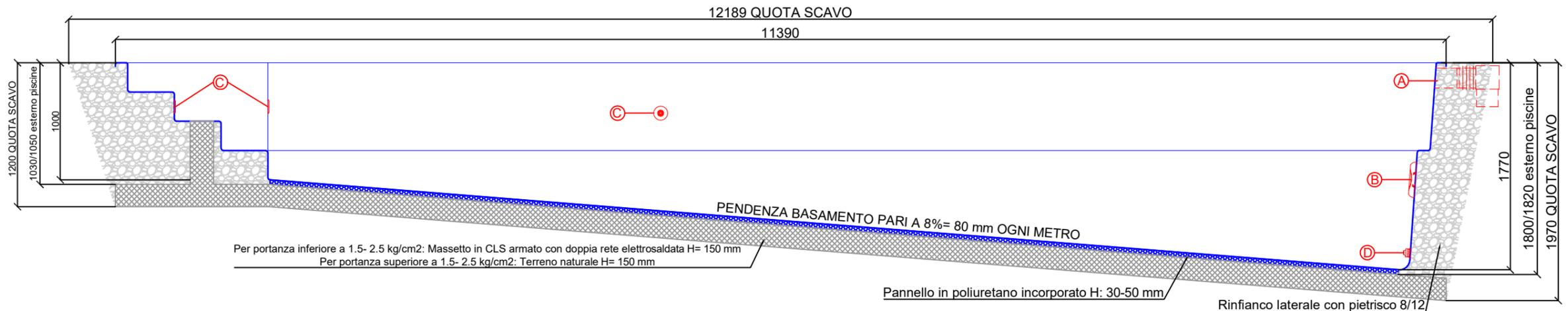
**UNICA INDICAZIONE VALIDA PER LA REALIZZAZIONE DEL BASAMENTO: PENDENZA DELL' 8%**
