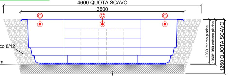
**UNICA INDICAZIONE VALIDA PER LA REALIZZAZIONE DEL BASAMENTO: PENDENZA DELL' 10,5%**
