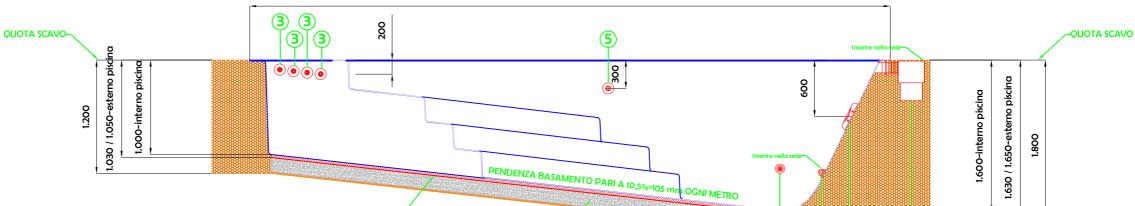
UNICA INDICAZIONE VALIDA PER LA REALIZZAZIONE DEL BASAMENTO: PENDENZA AL 10,5 %
