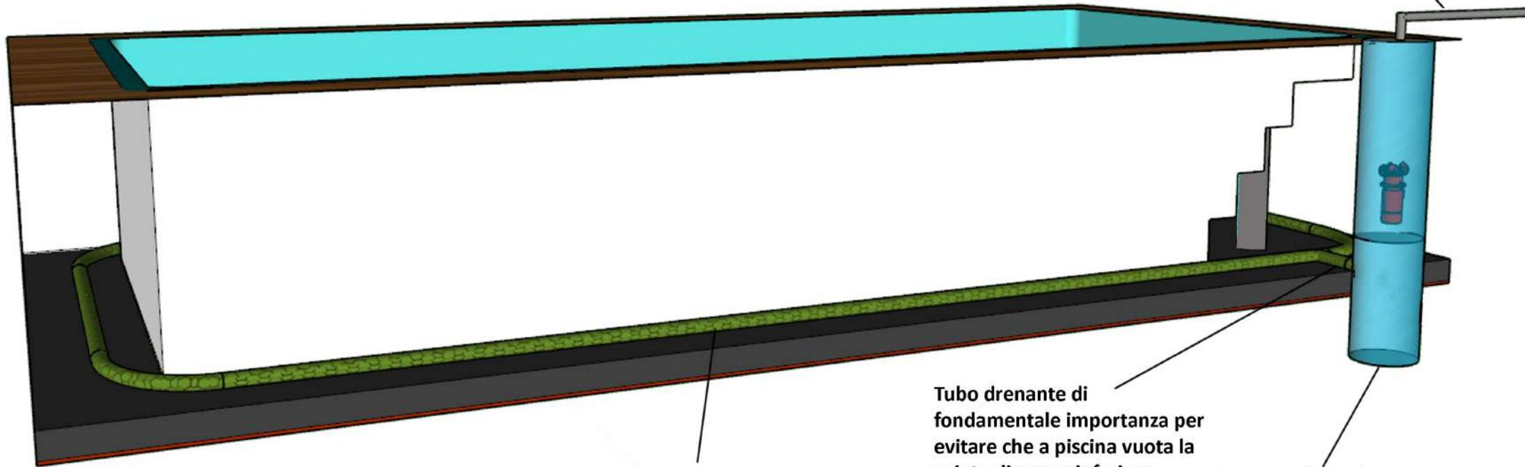
Tubazione  $\varnothing$  80/100 mm posata sul massetto di CLS
