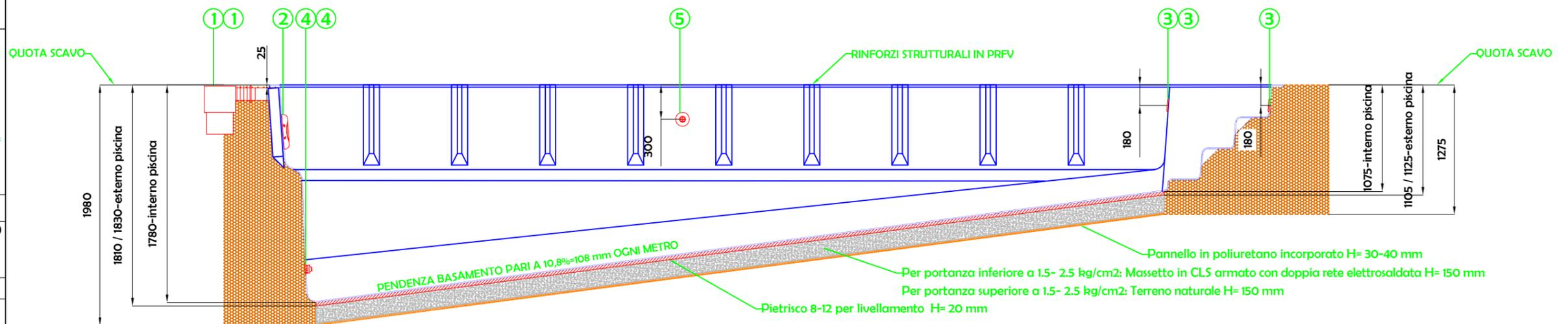
**UNICA INDICAZIONE VALIDA PER LA REALIZZAZIONE DEL BASAMENTO: PENDENZA AL 10,8 %**
